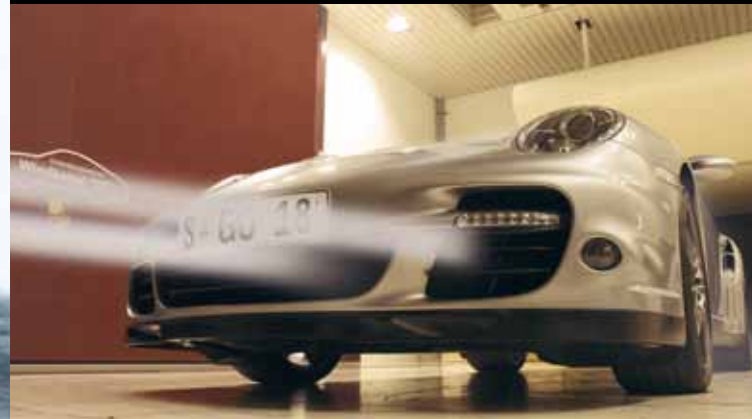
Im Lichttunnel wird die Lackierung geprüft.
