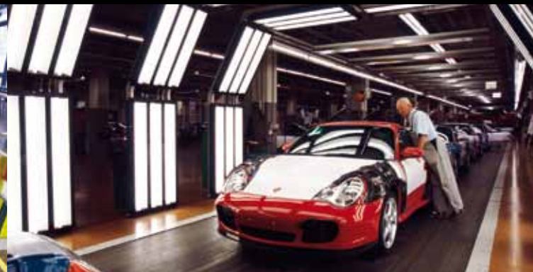
Im Lichttunnel wird die Lackierung geprüft.
