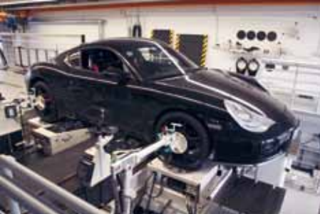
Messtechnik zur Fahrwerk-Erprobung.
